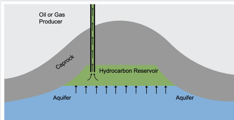
Fig. 1. [Bottom-water Drive Aquifer](#) schematic
