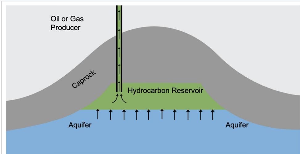
**Fig. 1.** [Bottom-water Drive Aquifer](#) schematic
